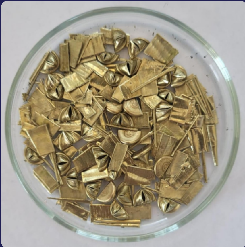
Zdjęcie 1: 9,945g łusek przed roztworzeniem w kwasie chlorowodorowym i nadtlenku wodoru
